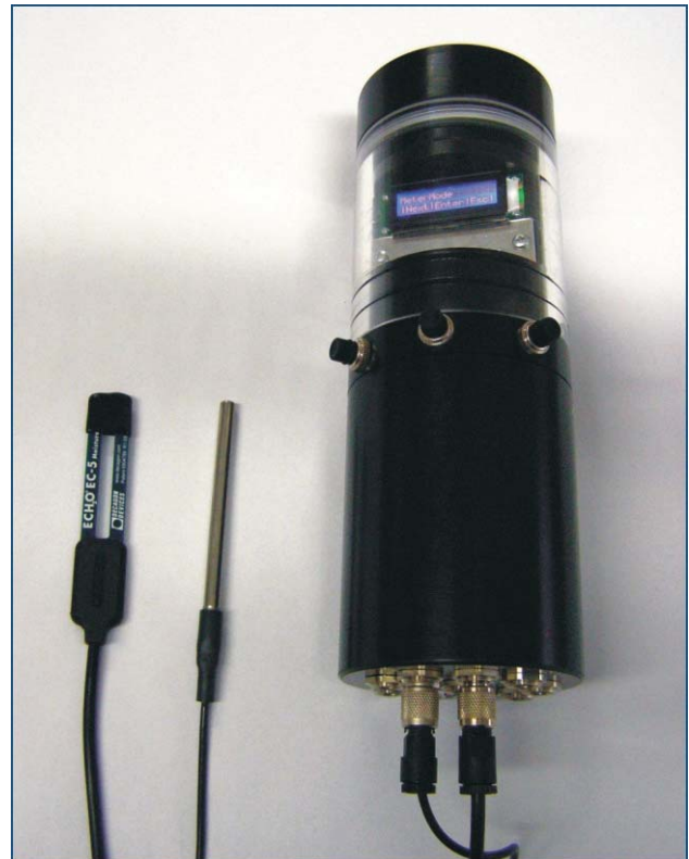
DK8040 mit angeschlossenen Bodenfeuchtesonde und Temperatursonde
