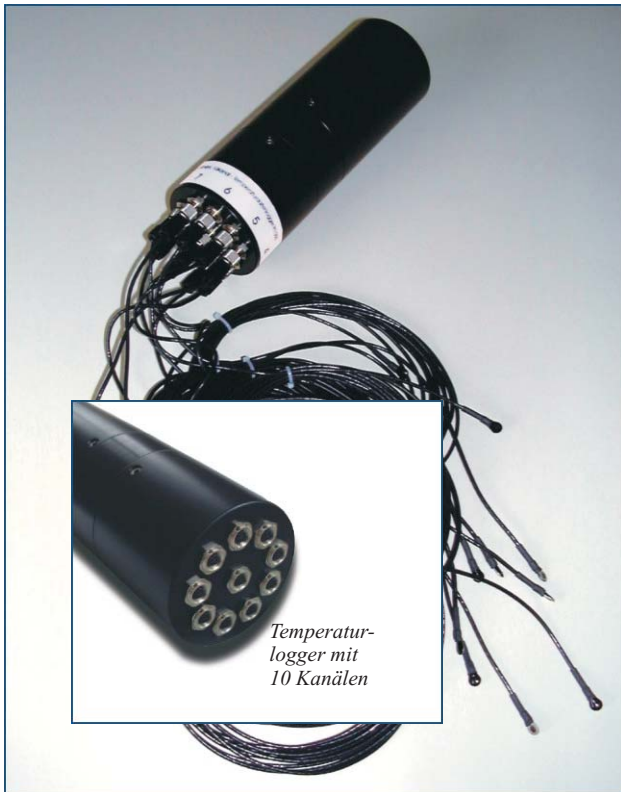
DK8040 z.B. mit 10 Oberflächentemperatur-Sonden
