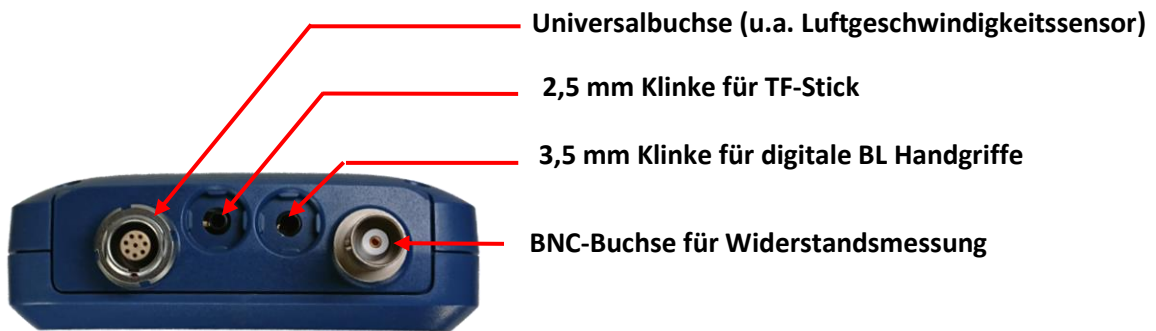
Abbildung 2-3: Stirnseite der Hydromette CH 17 mit Sensoranschlüssen
