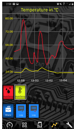
Abb. 16: Bildschirm "Grafiken" mit zwei Protokollen. Das rote Temperaturprotokoll ist als primäres Protokoll ausgewählt, so dass die Skalenwerte auf den Achsen nur für dieses Diagramm gelten.
